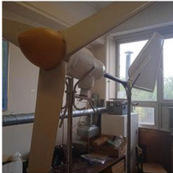
Рисунок 4.14 – Ветрогенератор с установленными датчиками
