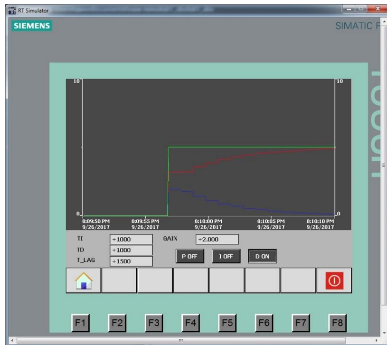
Рисунок 3.14 – Д-регулятор при T_D=1\text{с}
