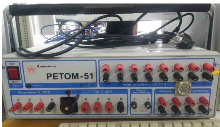
Рисунок 4.7 – Программно-технический комплекс Petom-51
