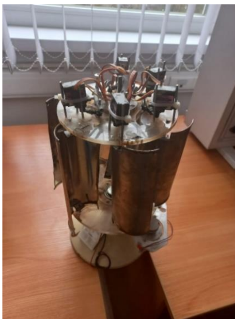
Рисунок 4.6– Экспериментальная модель ветрогенератора с разработанной системой управления
