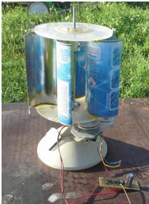
Рисунок 4.5 – Экспериментальная модель ветрогенератора без системы управления
